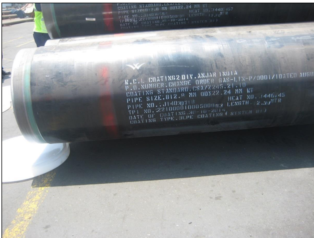
Foto-03: Tubería de 32"Ø de 22.2 mm de espesor (la franja roja indica la clasificación de la tubería según su espesor).
