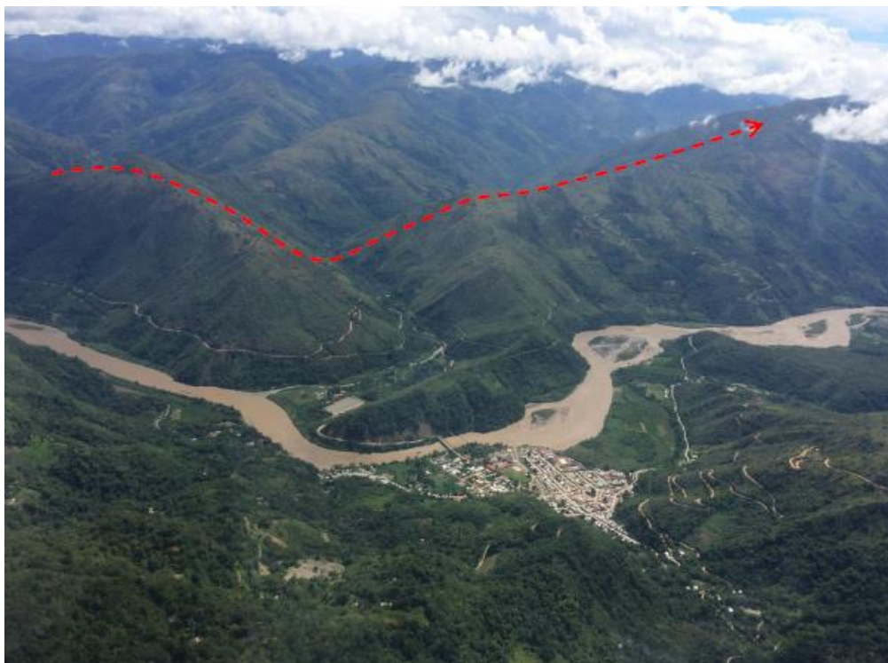
Foto-06: KP 136+000 al KP 141+000.- Trazo de la troncal del GSP atravesando por la línea de cumbres y quebrada de pendiente moderada, cerca al poblado de Palma Real.
