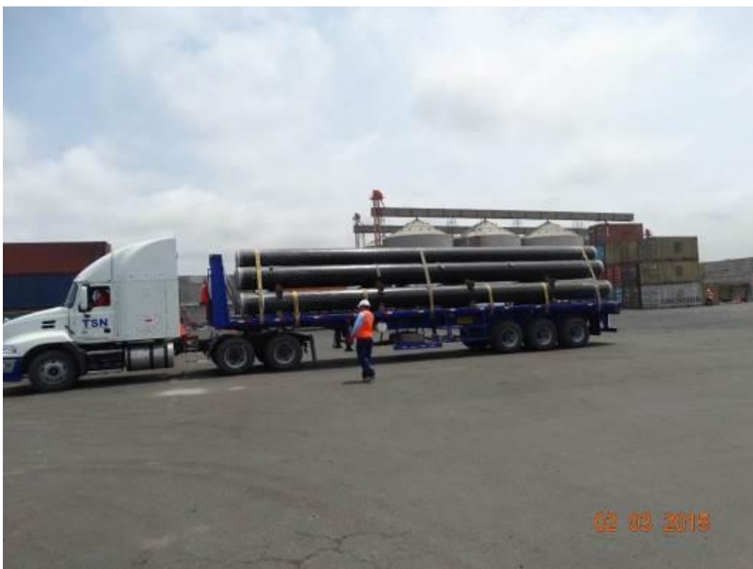
Foto-04: Camión trayler cargado con tubería de 24" listo para salir hacia Pucallpa.
