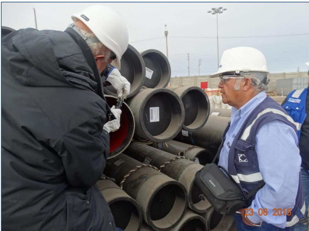
Foto 09. Verificando espesor de un tubo de 14" el cual fue de 8.86 mm que está por encima del espesor nominal, conforme
