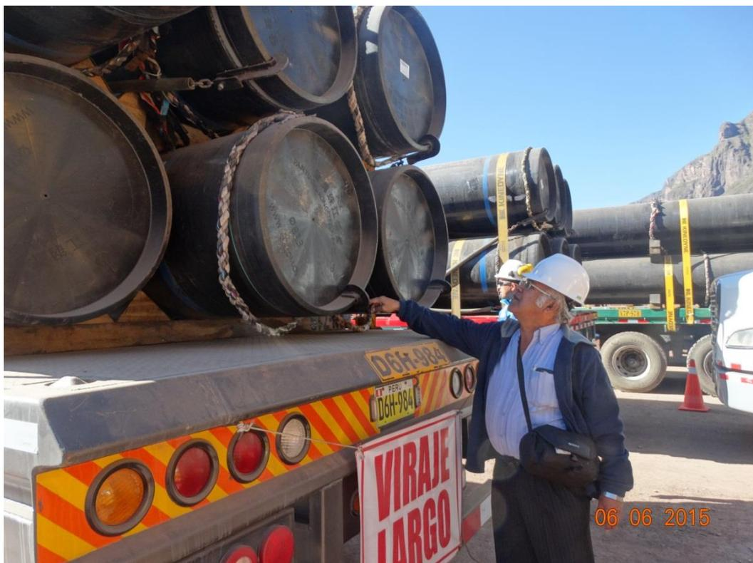
Foto 12. Centro de acopio de tubería Calca, nótese los ganchos y cadenas de retención de la tubería señalados por el supervisor de Osinergmin
