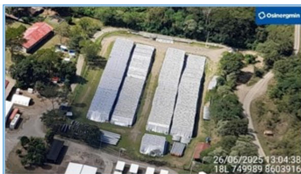
Área 3: Vista aérea del Acopio KP 136. Se aprecia las pilas de tubos cubiertos de lona para protección contra los rayos UV.
