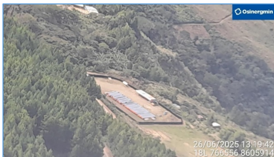
Área 3: Vista del acopio Acceso 10. Se aprecia las pilas de tubos cubiertos con lona para protección contra los rayos UV.
