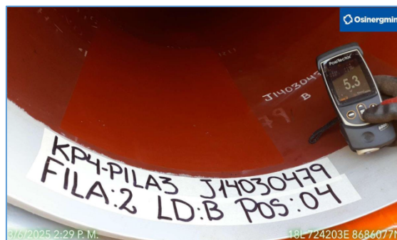
Área 1: KP 4+000. Verificación del estado de la reparación del revestimiento interno de la tubería.
