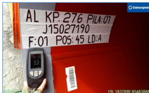
Área 4: Acopio KP 276. Verificación del estado del revestimiento interno de la tubería.
