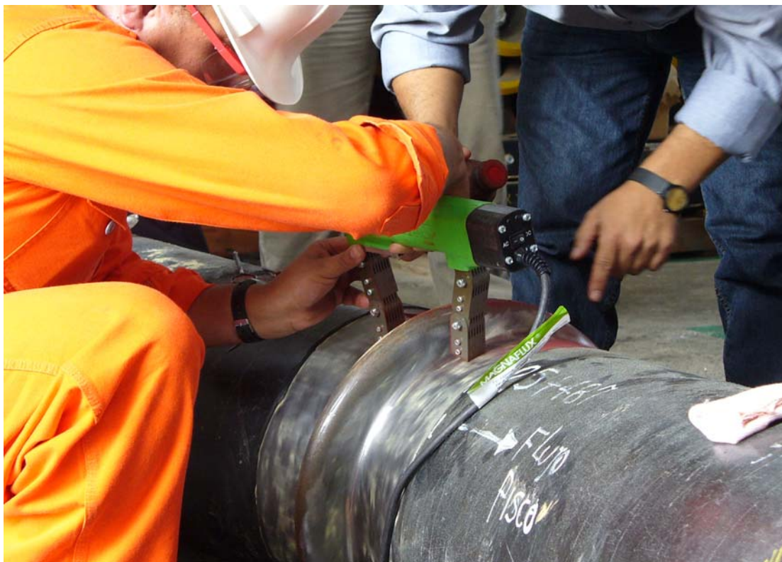
Inspección con partículas magnéticas- Magnaflux
