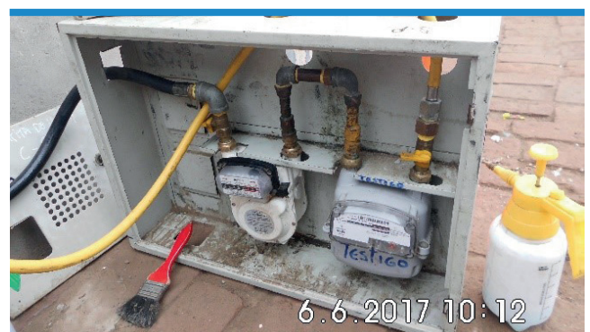
Contrastación de medidor residencial con medidor patrón, distrito y Provincia de Pisco.
