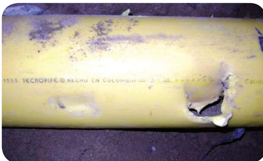
Daño en el ducto de polietileno
