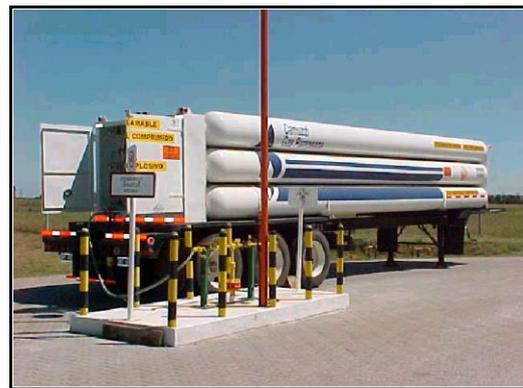
Figura 5. Tanques para transporte de GNC en camiones.
