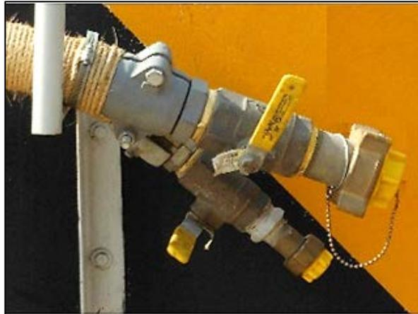
Una válvula de cierre rápido en el extremo libre de la manguera de trasiego de GLP.
