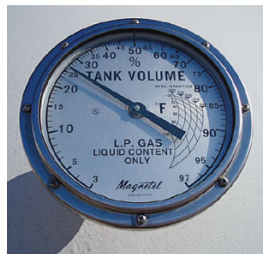
Medidor de nivel de líquido variable. Medidor magnético. Fuente: Exhibit 5.40 del Handbook NFPA 58, edición 2017.
