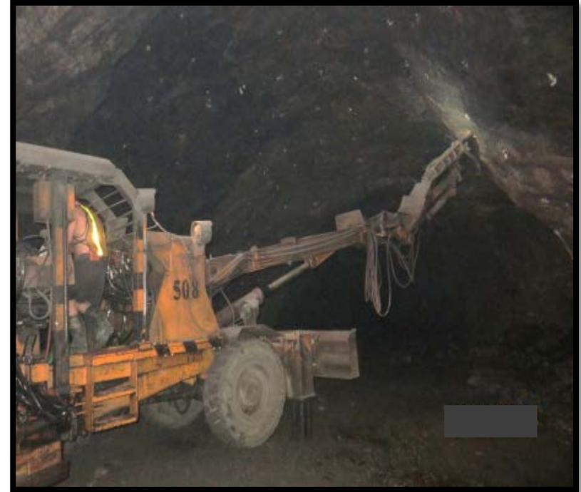
Desate de rocas mecanizado, utilizando Scaler
