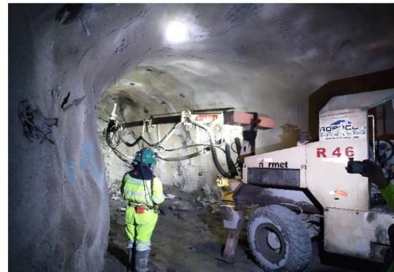
Sostenimiento con shotcrete, de forma manual. Sostenimiento con shotcrete, de forma mecanizada.
