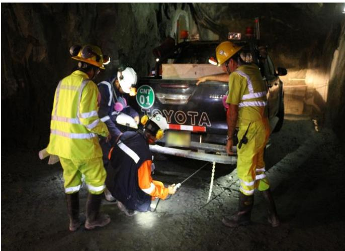
*Verificación de la emisión de gases por el tubo de escape de los equipos petroleros que laboran en interior mina: No deben ser mayores a los 500 ppm para el monóxido de carbono (CO) y 100 ppm para el dióxido de nitrógeno (NO<sub>2</sub>).*
