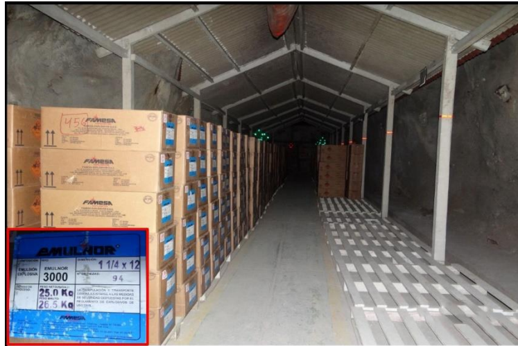
Interior del polvorín permanente ubicado en el Nv 3189, UM Catalina Huanca Fuente: Osinergmin
