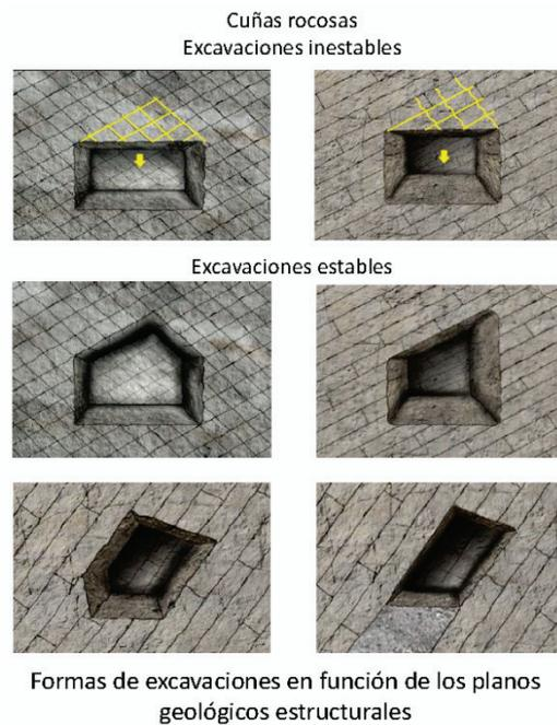
Figura 8-10. Excavaciones estables e inestables en roca diaclasada (SNMPE, 2004)
