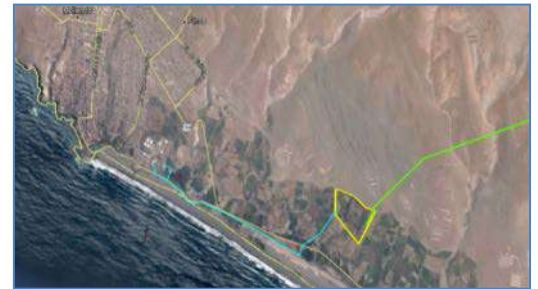
Trazo de Línea de Transmisión 500 kV
