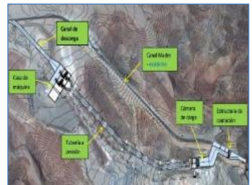
Obras que integran el proyecto
